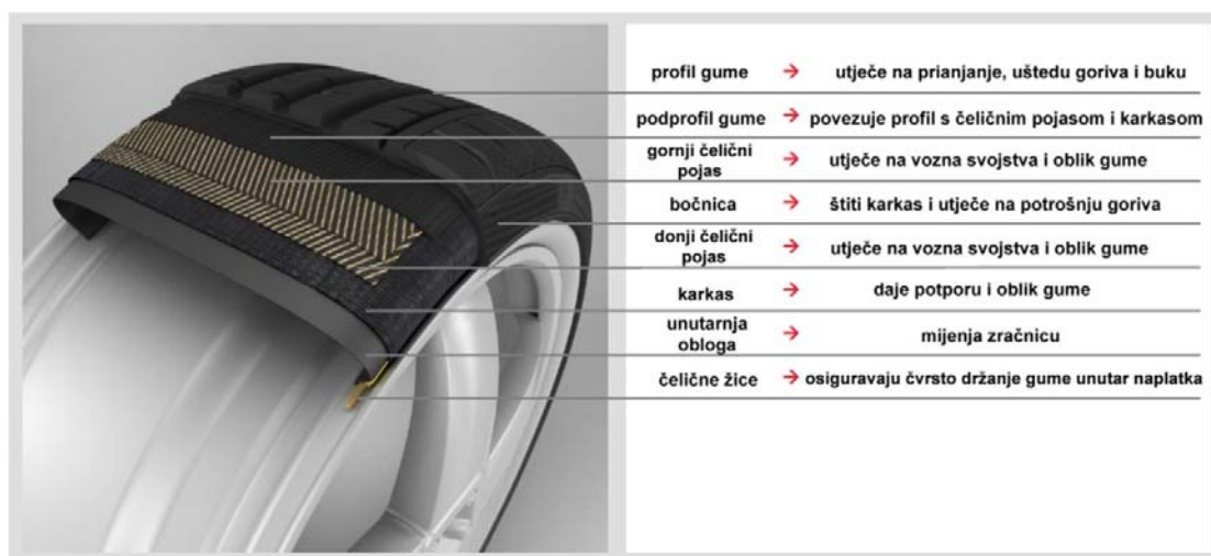
Slika 2.1. Podjela automobilske gume na osam slojeva, izvor: [2]
