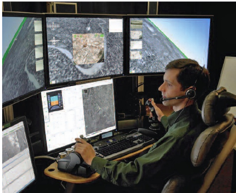
Slika 29. Univerzalni kontrolni sustav tvrtke Raytheon, dizajniran u skladu s NATO standardom STANAG 4586.
