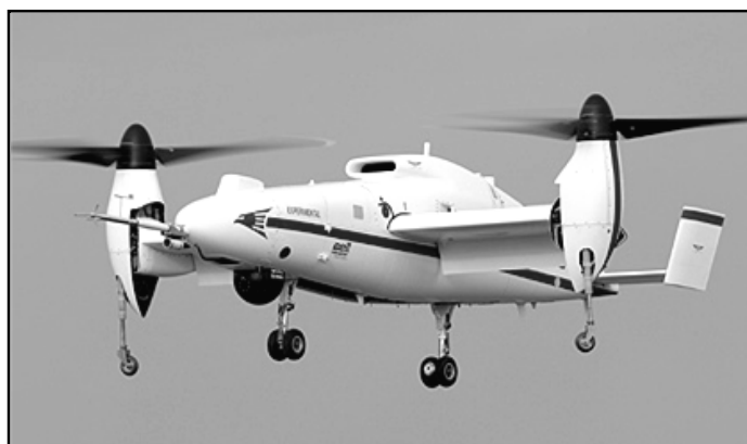
Slika 7. Besposadni zrakoplov srednjeg doleta s vertikalnim polijetanjem, Bell TR918 Eagle Eye
