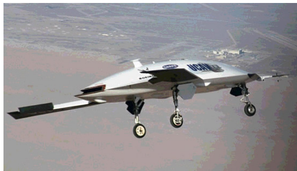
Slika 9. Besposadni zrakoplov kategorije UCAV u zajedničkom razvojnom programu američke agencije DARPA te američkog zrakoplovstva i mornarice
