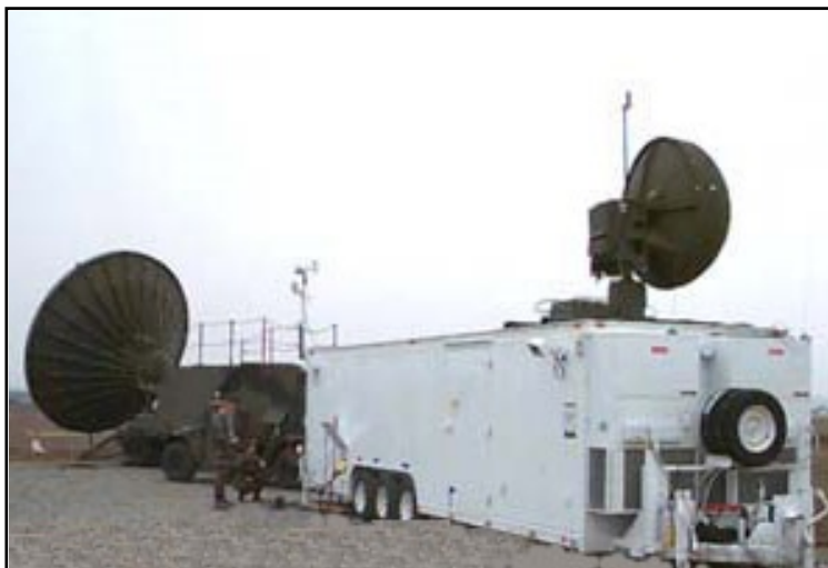
Slika 31. Tipični izgled zemaljske kontrolne stanice, u ovom slučaju za besposadni zrakoplov tipa Predator.
