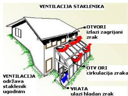
Slika 14 - Prikaz funkcioniranja ventilacije staklenika
