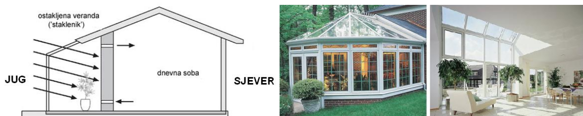
Slika 13 – Staklenik - shematski presjek i dva primjera izvedbe
