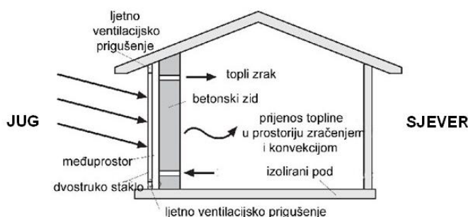
Slika 9 - Trombov zid
