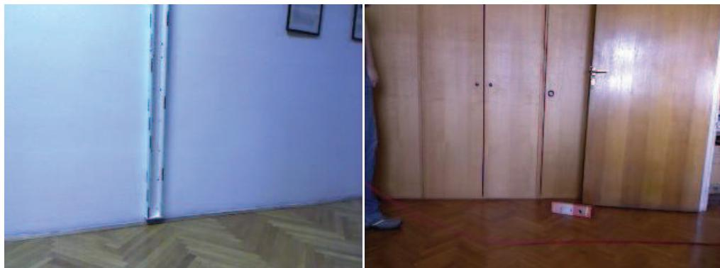
Slika 6.17. Primjeri slika gdje predloženi algoritam ne uspijeva generirati hipotezu zato što scena ne sadrži dovoljno informacija za procjenu zadnjeg stupnja slobode gibanja robota.
