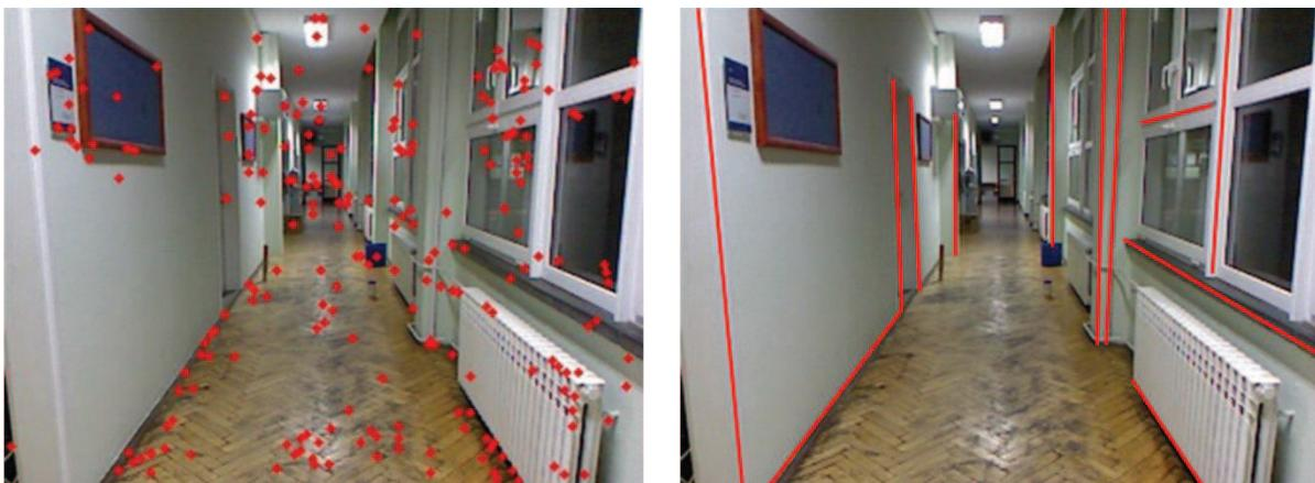
Slika 2.13. Točkaste i linijske značajke.
