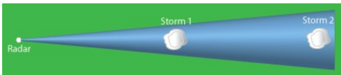
Slika 4. Ilustracija dvije identične oluje na različitim udaljenostima obuhvaćene jednom radarskom zrakom.
