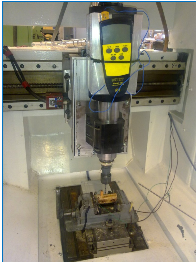
Slika 46. Prikaz izvođenja pokusa glodalicom Flexmatic FA 530 S
