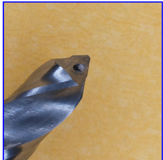
Slika 63. Oštrica prvog stupnja dvostupnjevanog spiralnog svrdla promjera 3.4/4.5 mm nakon 180 bušenja
