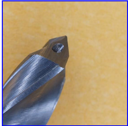
Slika 57. Oštrica spiralnog svrdla promjera 4.5 mm nakon 180 bušenja
