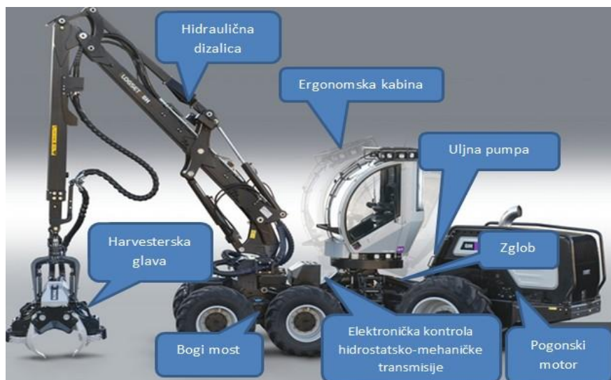
Slika 3. Dijelovi harvestera
