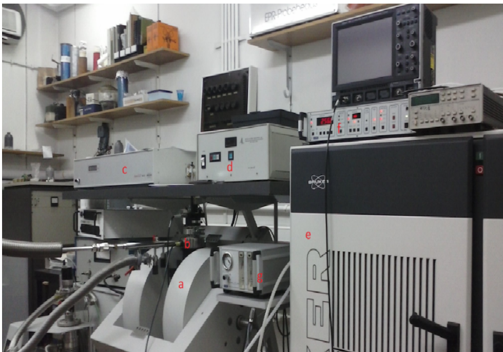
Slika 3.7: Laboratorij za magnetske rezonancije na Institutu "Ruđer Bošković". Dijelovi označeni na slici su: a) – elektromagnet (magnetsko polje do 1 T), b) –kriostat u središtu magnetskog polja u koji je smješten uzorak, c) – mikrovalni most frekvencije oko 9.5 – 9.7 GHz, d) – upravljačka konzola, e) –pojačalo mikrovalova pri impulsnim mjerenjima , f) – temperaturna jedinica (temperatura 4-295 K), g) – pumpa koja vuče helij iz spremnika za helij u kriostat.
