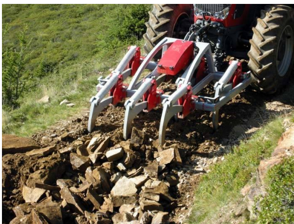
Slika 7. Rijač priključen na prednji hidraulički podizač traktora. (Izvor: www.pthproducts.com )
