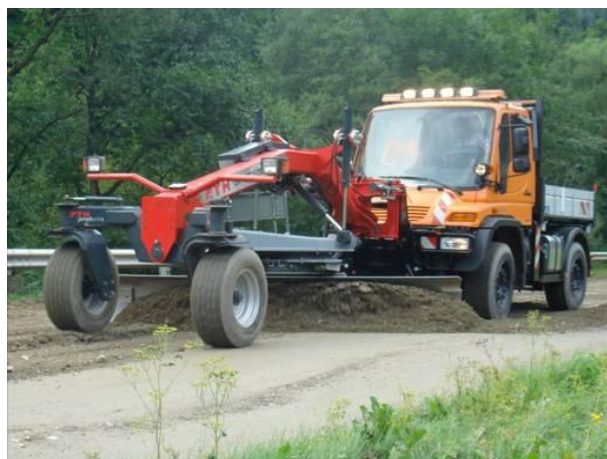
Slika 8. Grejder na prednjem kraju Unimog-a. (Izvor: www.pthproducts.com )
