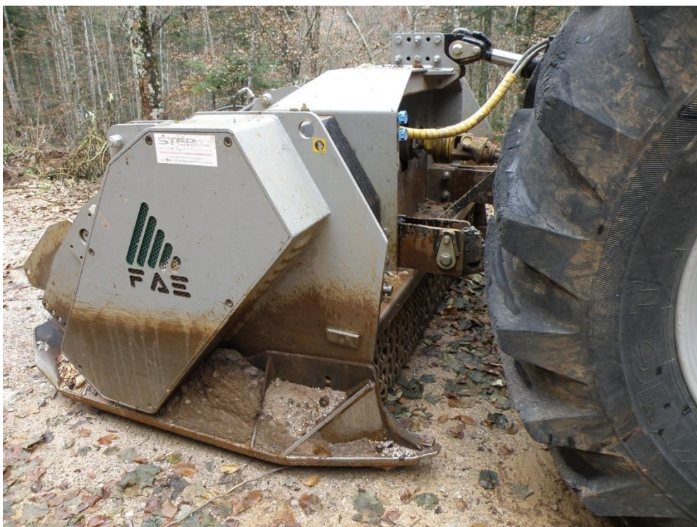
Slika 4. Prikaz rotacijske freze za kamen talijanskog proizvođaća FAE. (Izvor Ńušnjar i dr. 2009)
