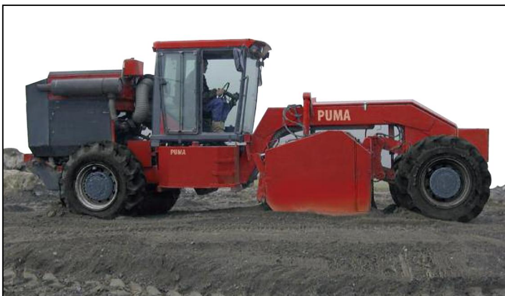
Slika 1. Samohodna sitnilica kamena PUMA 503. (Izvor: www.oelzgmbh.com )
