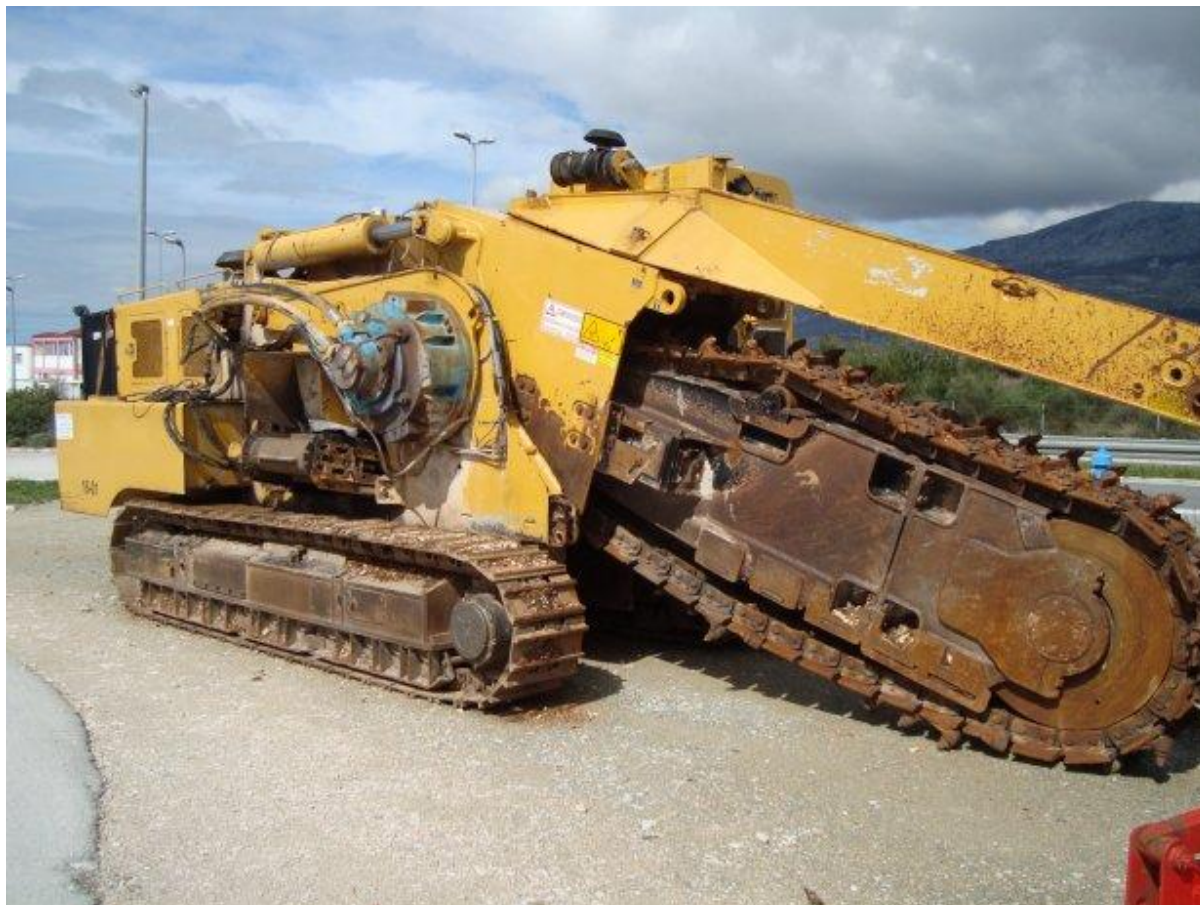
Slika 2. Samohodna drobilica kamena - Vermeer T855 Commander(Izvor: www.Vermeer.com )
