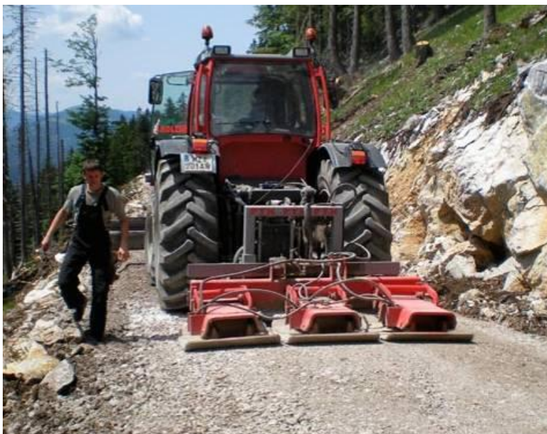
Slika 9. Uređaj za sabijanje usitnjenog materijala na cesti proizvođača PTH (Izvor: www.pthproducts.com )
