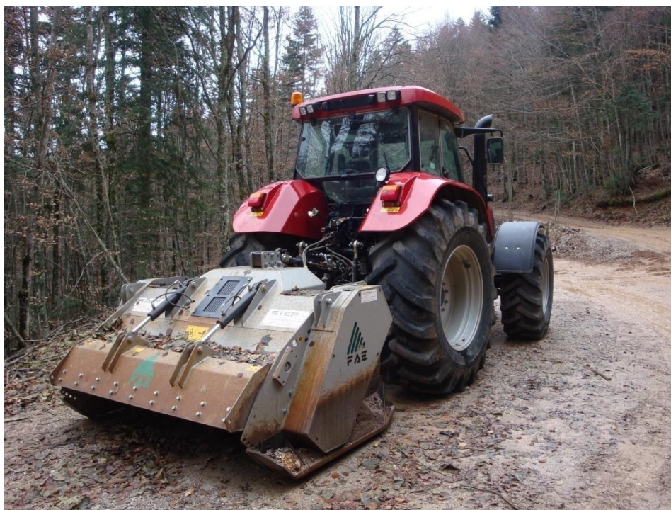
Slika 10. Prikaz kamenske sitnilice marke .FAE STCH/SD-200 (Izvor: Šušnjar i dr.2009)
