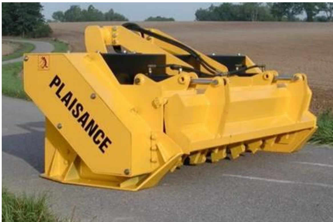
Slika 5. Rotacijska sitnilica za kamen francuskog proizvođača Plaisance (Izvor:
