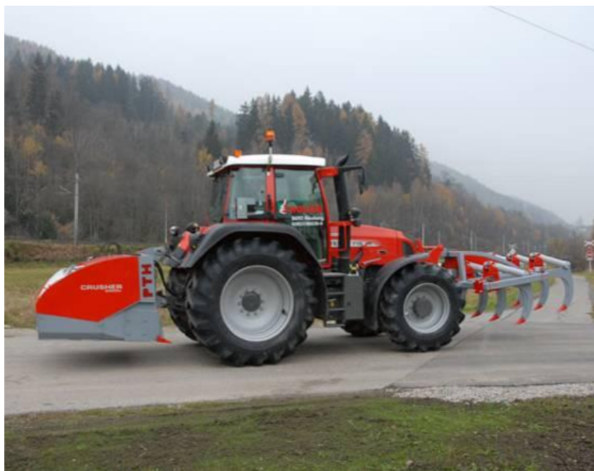
Slika 6. PTH rotacijska sitnilica kamena i riper na poljoprivrednom traktoru.
