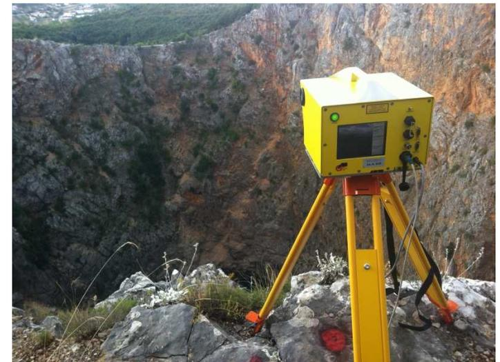
**Kreiranje preciznog 3D geometrijskog modela površinskog dijela jezera**
