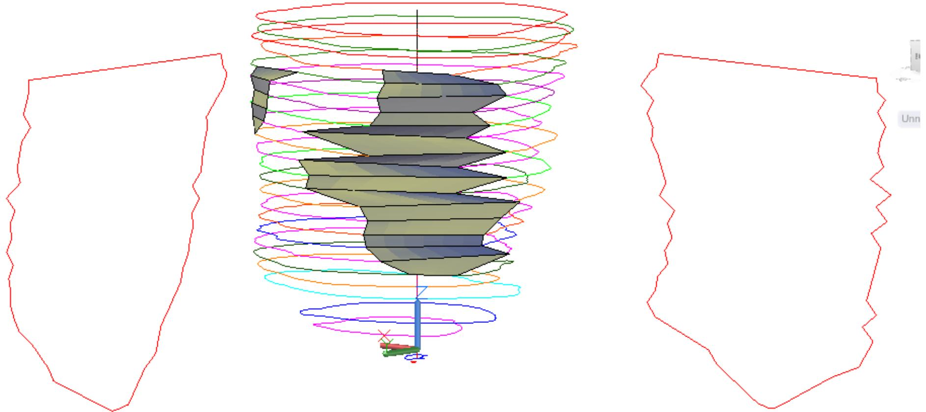
**Kreiranje 3D geometrijskog modela podpovršinskog dijela jezera**
