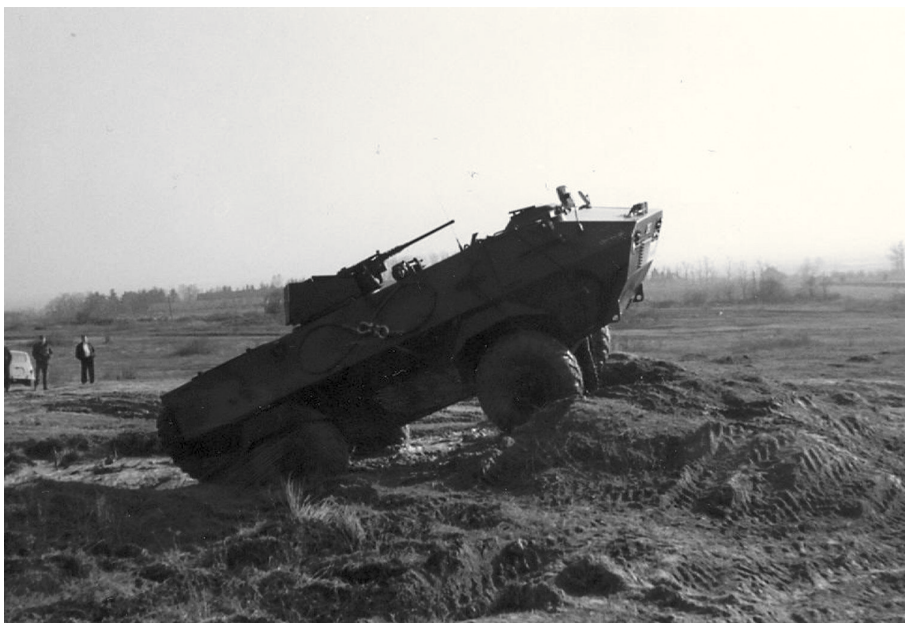
Slika 4 Ispitivanje prototipa LOV 4x4 s PZO strojnicom 12.7 mm, Jastrebarsko, 1993.
