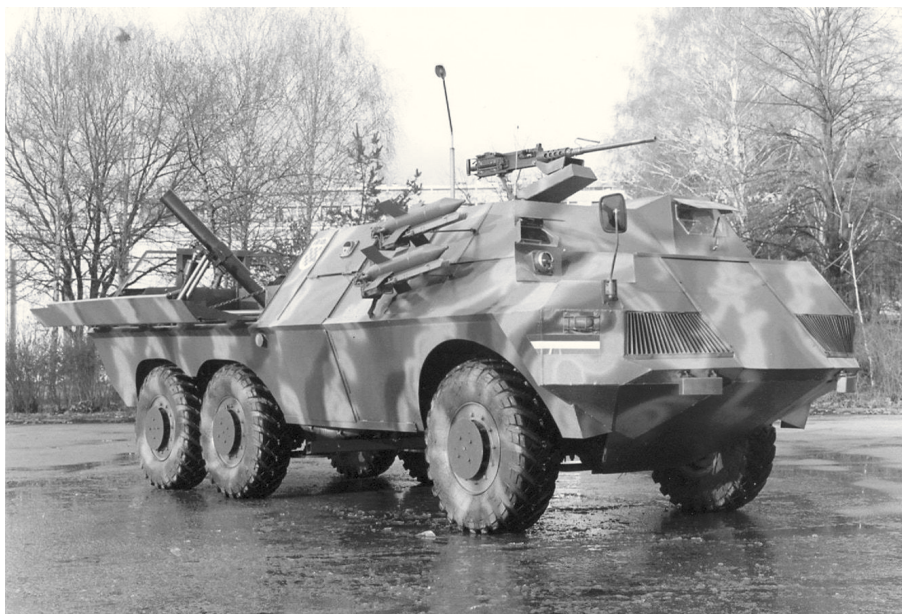
Slika 2 Funkcionalni model, Samovozni minobacač SoMB-120 s PZO strojnicom 12.7 mm, „KISELI“, Brodarski institut, Zagreb 1991.
