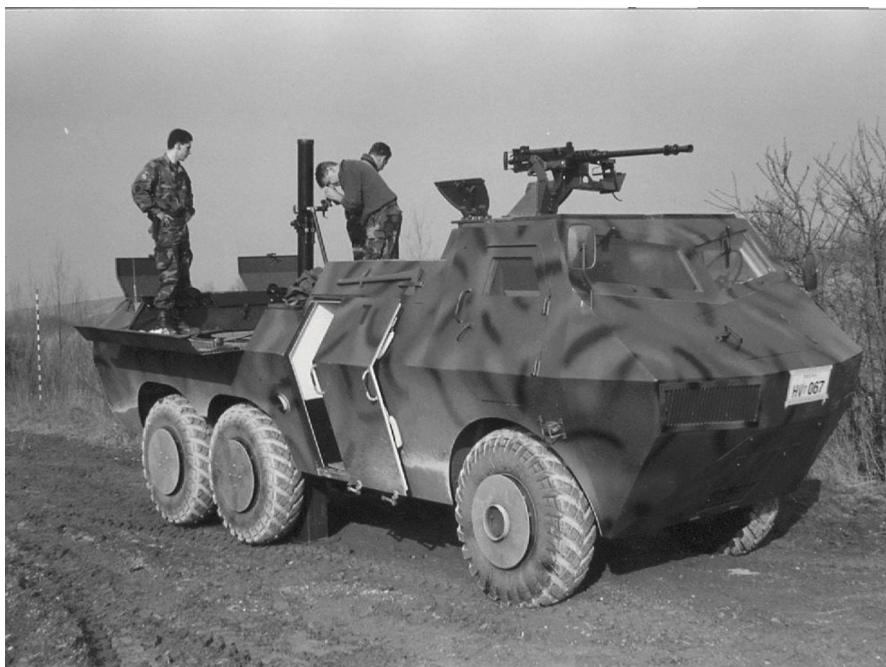
Slika 3 Ispitivanje prototipa, Samovozni minobacač SoMB-120 s PZO strojnicom 12.7 mm, „KISELI“, Brodarski institut, Zagreb 1991.
