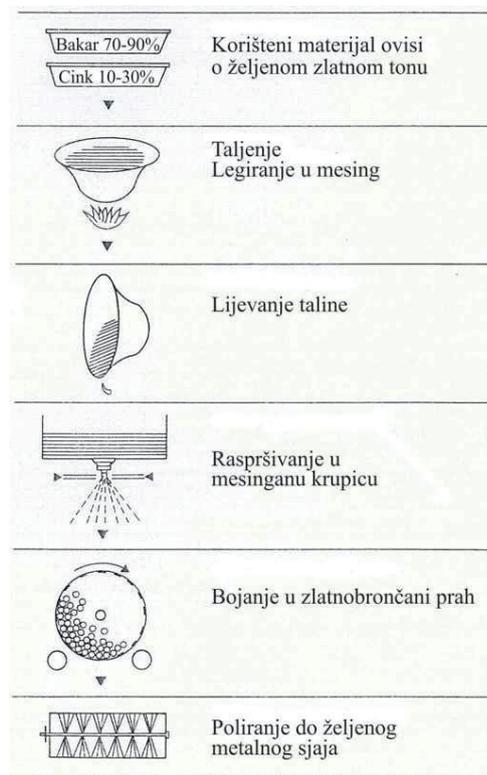
Slika 10. Shematski prikaz izrade mesingastog praška koji se koristi za simuliranje zlata
