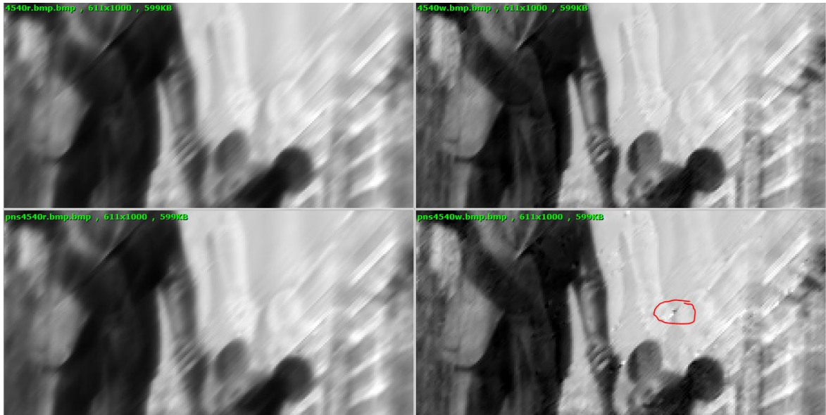
Slika 15 - Usporedba Wiener i R-L algoritma bez šuma i sa PNS šumom
