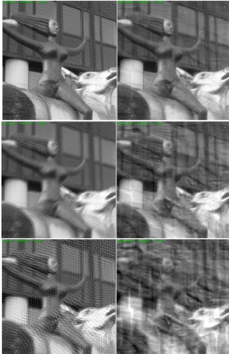
Slika 19 - Utjecaj pogreške procjene duljine na rekonstrukciju
