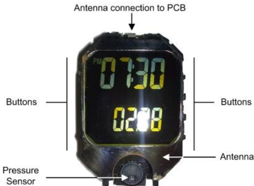
Slika 2. Prikaz vanjskog sklopovlja na eZ430 Chronos satu
