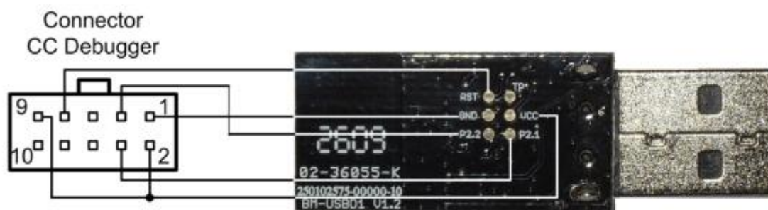
Slika 6. Spajanje CC Debuggera na pristupnu točku
