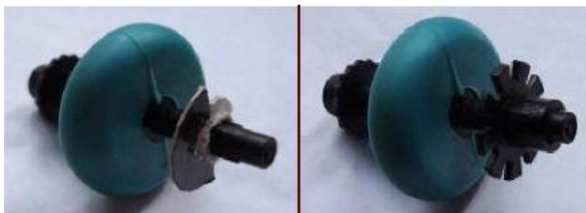
Slika 15. Izrađena maskica i postojeći kotač
