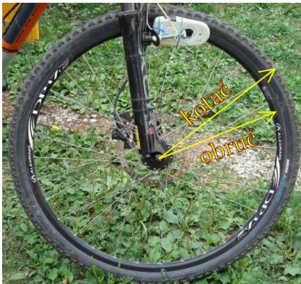
Slika 17. Razlika polumjera obruča i kotača
