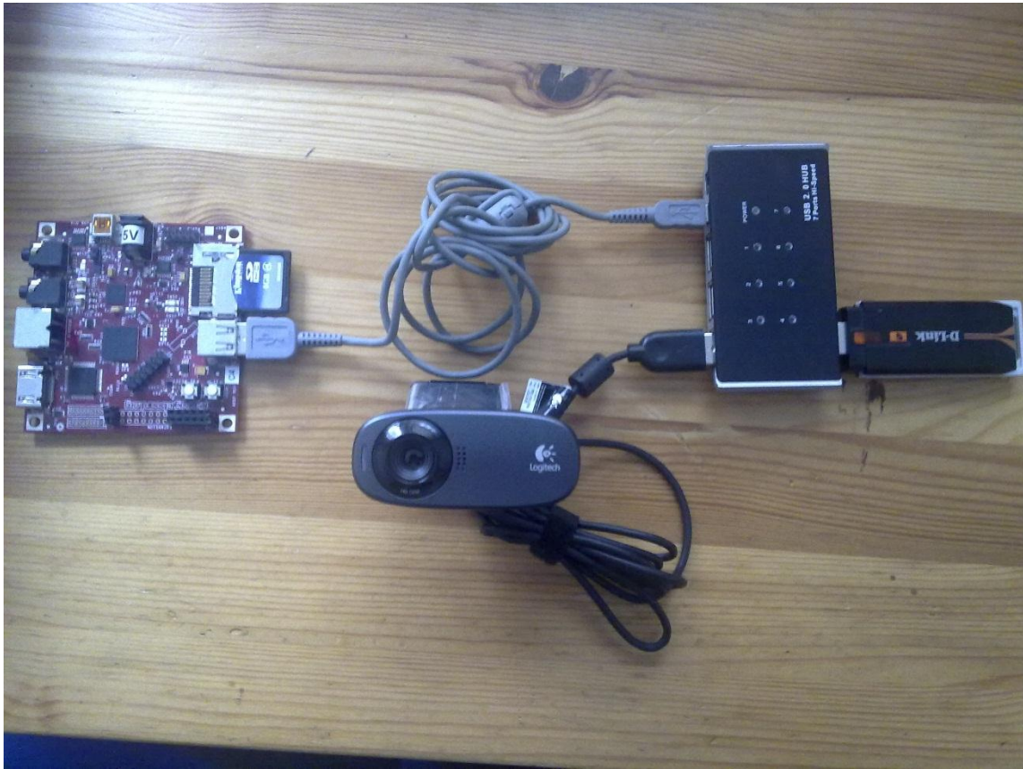
Slika 8: modificirana Beagleboard pločica spojena na USB hub
