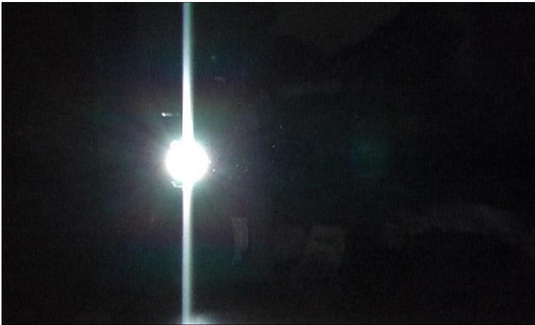
SI 1.3 Primjer vertikalnog razmazivanja ( vertical smear ) kod CCD optičkih senzora ( https://en.wikipedia.org )
