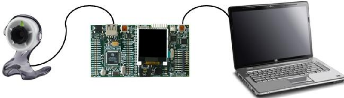
Slika 19. Prikaz spajanja sustava preko serijske RS-232 veze sa računalom
