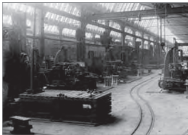
Sl. 23. Pogoni tvornice već su od kraja 19. stoljeća izvrsno opremljeni. Velike su hale rasvijetljene prirodnom i električnom rasvjetom, pogoni su povezani tračnicama, a “mosne” dizalice poput ove na slici, olakšavaju prenošenje i utovar pojedinih teških dijelova torpeda i opreme. (Società di Studi Fiumani – Archivio Museo Storico di Fiume, Rim)
