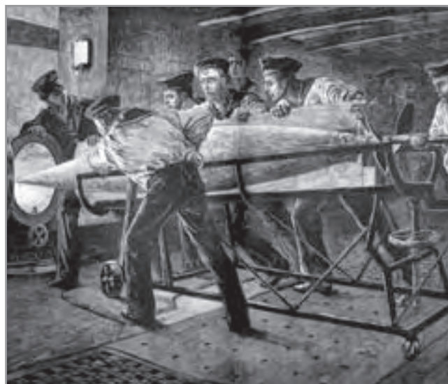
Sl.10. Na grafici iz Illustrated London News od 18. svibnja 1878. objavljen je prizor lansiranja s broda Thunderer . Torpedo je do cijevi doveden na posebnim kolicima, s mogućnošću podizanja do najpogodnije visine za uguravanje u cijev. (Illustrated London News, 18. svibnja 1878.)
