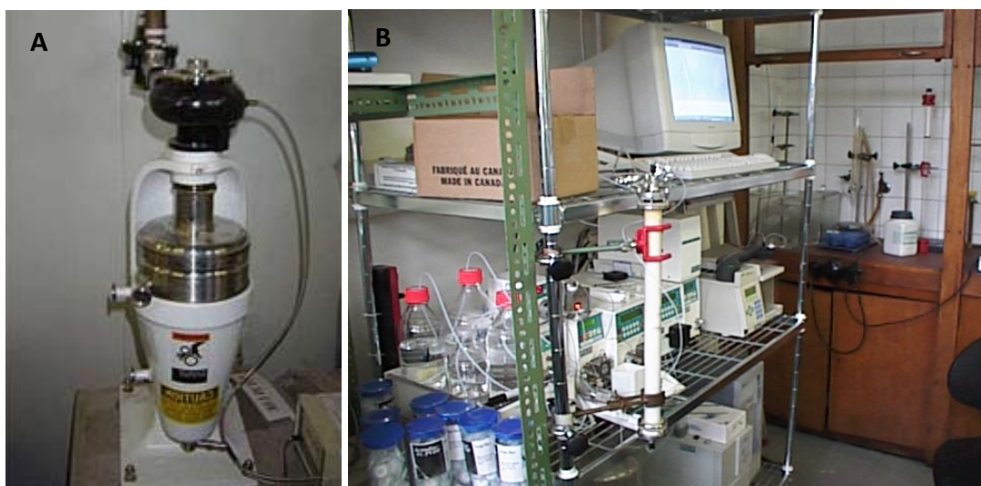
Slika 27. A - centrifuga Sharples (model T-1); B - preparativni kromatografski sustav.
