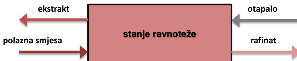
Slika 23. Dijagram toka jednostupanjskog uravnoteženog procesa ekstrakcije s prikazanim varijablama tokova (pretpostavljeno je da se dvije faze međusobno ne miješaju).
