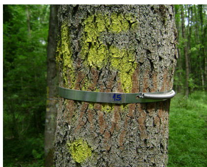
Slika 2.8. Dendrometarska traka montirana na stablo hrasta lužnjaka broj 15.
