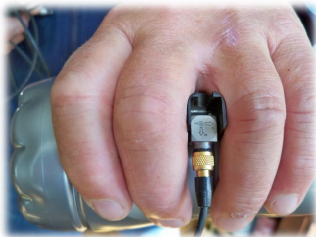
Slika 6. Prihvat troosnog akcelerometra tijekom mjerenja bez rukavica
