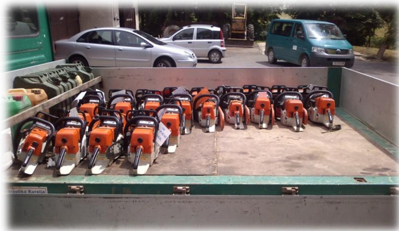
Slika 1. Motorne pile spremne za mjerenje vibracija
