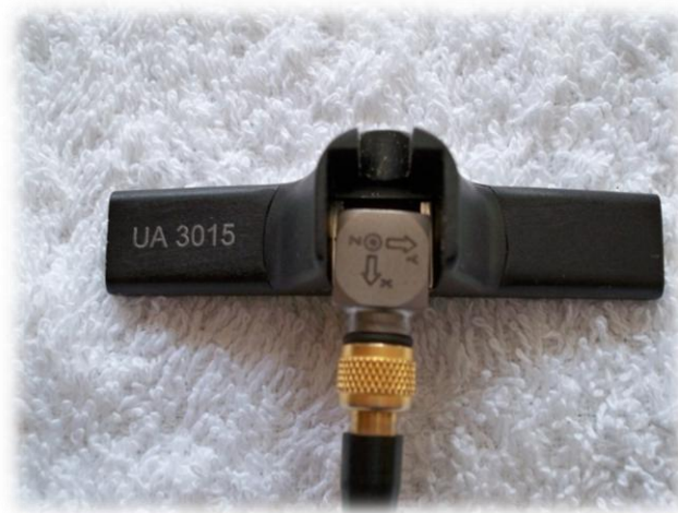
Slika 5. Pričvršćenje troosnog akcelometra na nosač
