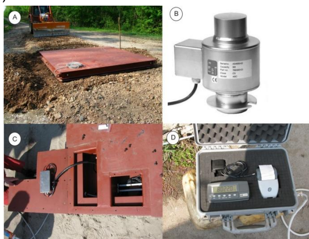
Slika 5. Prijenosna mjerna platforma i njezini sastavni dijelovi
