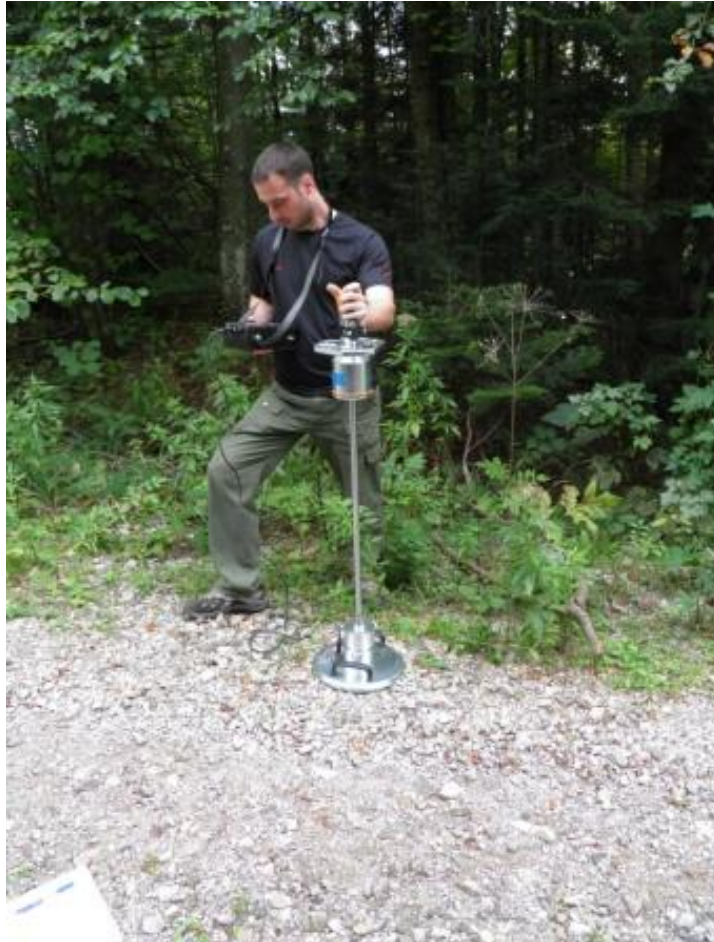
Slika 11. Provedba mjerenja nosivosti šumske ceste
