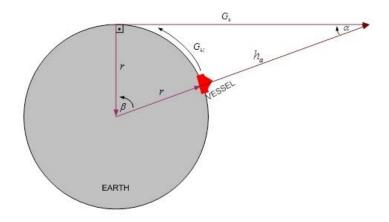
Figure 1 Geometric horizon ( $G_h$ ) Slika 1 Geometrijski horizont ( $G_h$ )
