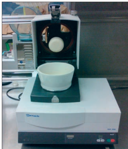
Slika 18. Poseban mlin za usitnjavanje tla
