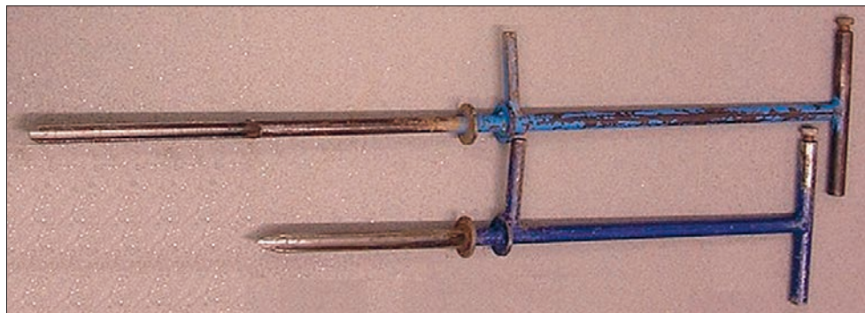
Slika 26. Sonde za uzorkovanje oraničnoga i podoraničnoga sloja tla
