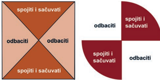
Slika 25. Smanjivanje mase prosječnoga uzorka "četvrtanjem"
