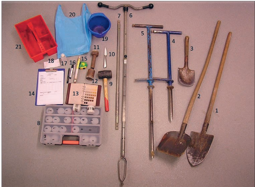
Slika 4. Pomagala i pribor za sondiranje i uzorkovanje tla
