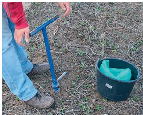
Slika 27. Uzorkovanje pojedinačnoga uzorka tla sondom
