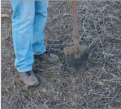
Slika 28. Uzorkovanje pojedinačnoga uzorka tla štijačom
