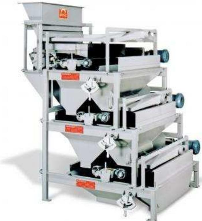
*Slika 7-12. Visokointenzivni bubenjasti magnetski separator s magnetom od rijetkih metala tipa ERIEZ Rare Earth Roll (RE) Separators (Eriez, 2014a)*
