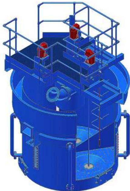
Slika 7-10. Uzgonski (protustrujni) klasifikator MEP Hydrosizer/TBS (MEP, 2014))
