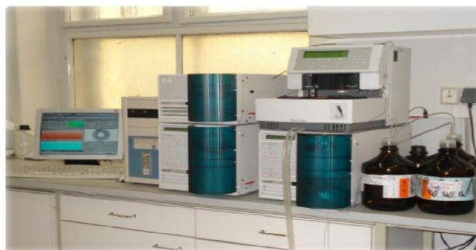
Slika 4. Tekućinski kromatograf visoke djelotvornosti, Varian ProStar 500, s detektorom s nizom dioda (HPLC-DAD)
