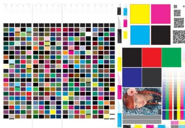
Slika 10. Digitalna tiskovna forma primijenjena za eksperimentalno otiskivanje
