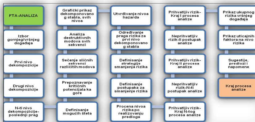
Slika 9. FTA metod: prikaz koraka pri analizi interakcije događaja i grešaka, (Adaptirano za tehničke sisteme u rudarstvu)
