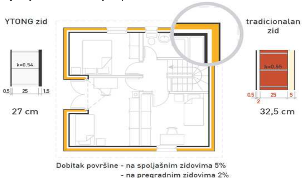
Slika 3. Uporedna analiza Ytong i tradicionalnog zida [16].
