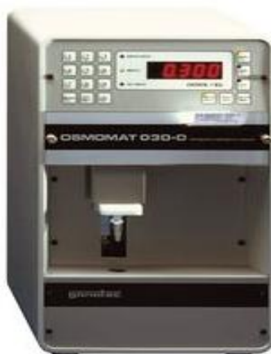
Slika 9. Prikaz krioskopskog osmometra (preuzeto i modificirano s www.pintertrade.com )
