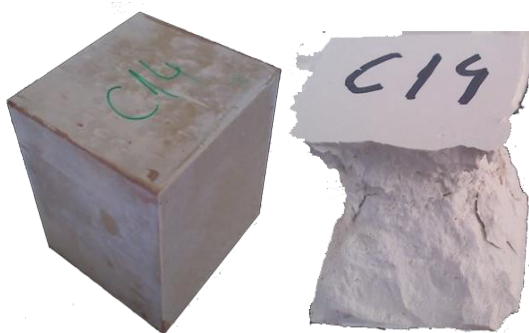
Slika 7. Uzorak C14 prije i nakon ispitivanja tlačnih čvrstoća
