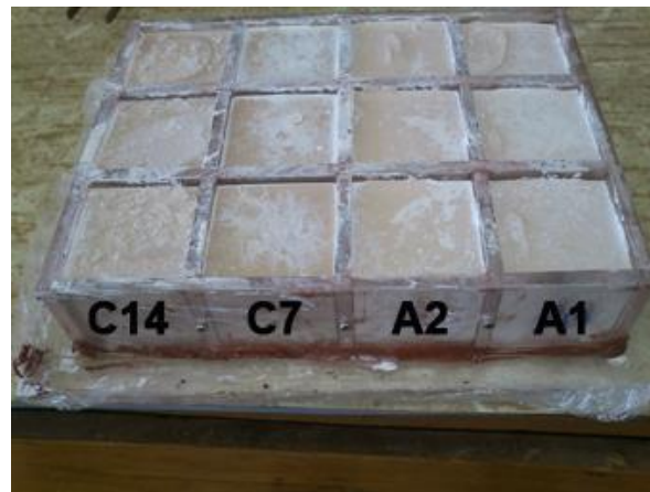
Slika 3. Pripravljeni uzorci geopolimernih smjesa nakon provedenog procesa termičke aktivacije
