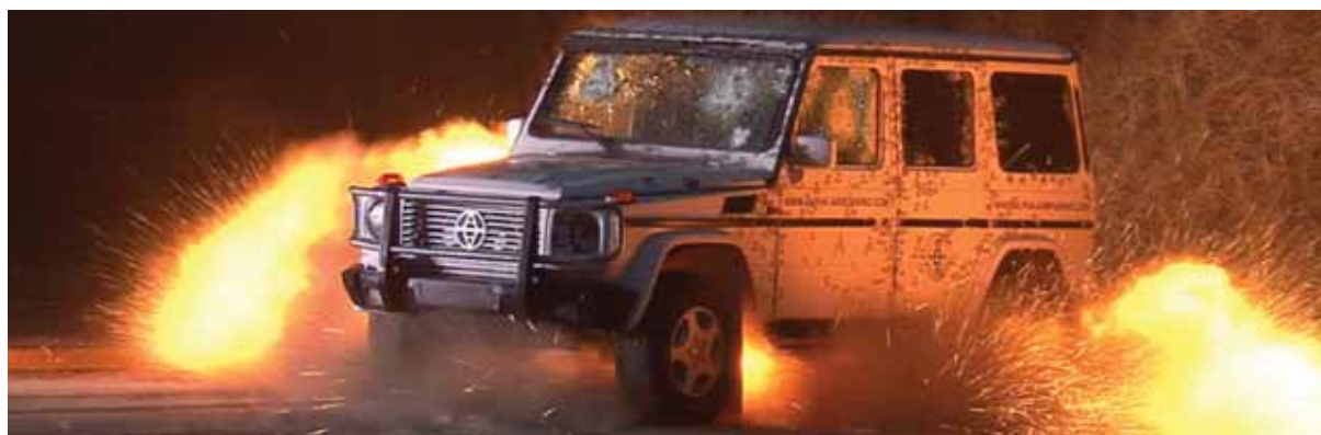
Slika 6. Testiranje razine zaštite od eksplozivnih naprava (www.texasarmoring.com)
