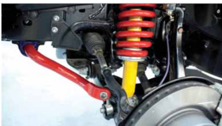
Slika 16. Ojačanje ovjesa zbog povećane vlastite mase vozila
