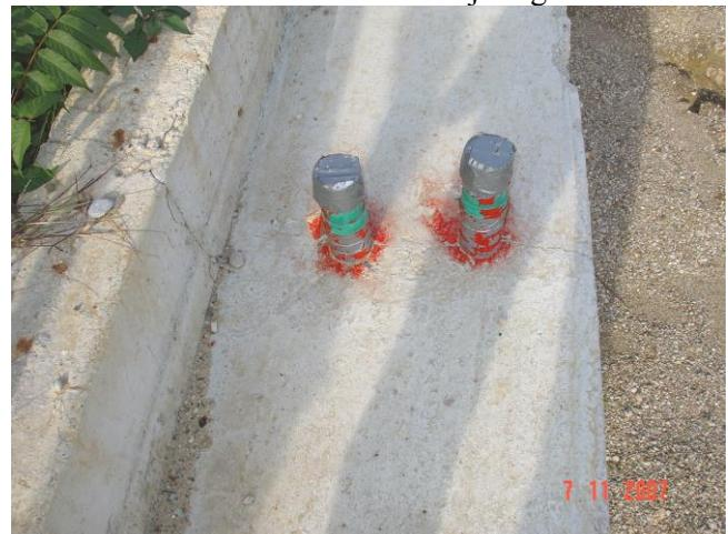
Slika 9 Vrhovi mikrometarskih, odnosno inklinometarskih cijevi (Lebo, 2010)
