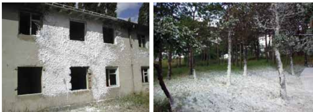
Slika 2. Prijanjanje pjene dobivene CAFS-om na vertikalnu površinu i na vegetaciju
