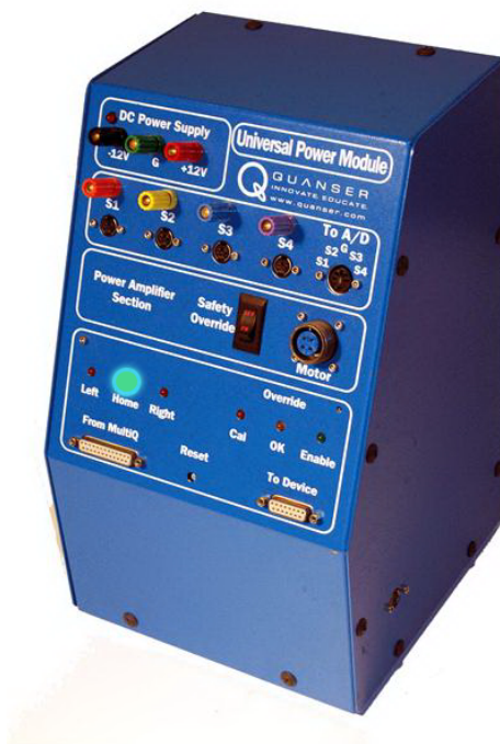
Slika 8: Modul za napajanje (UPM-180-25B) potresnog stola na kojemu svijetli zelena lampica iznad riječi Home
