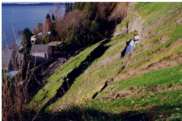
Slika 4 Čeona, vlačna pukotina na aktivnim klizištima prije konačnog sloma
