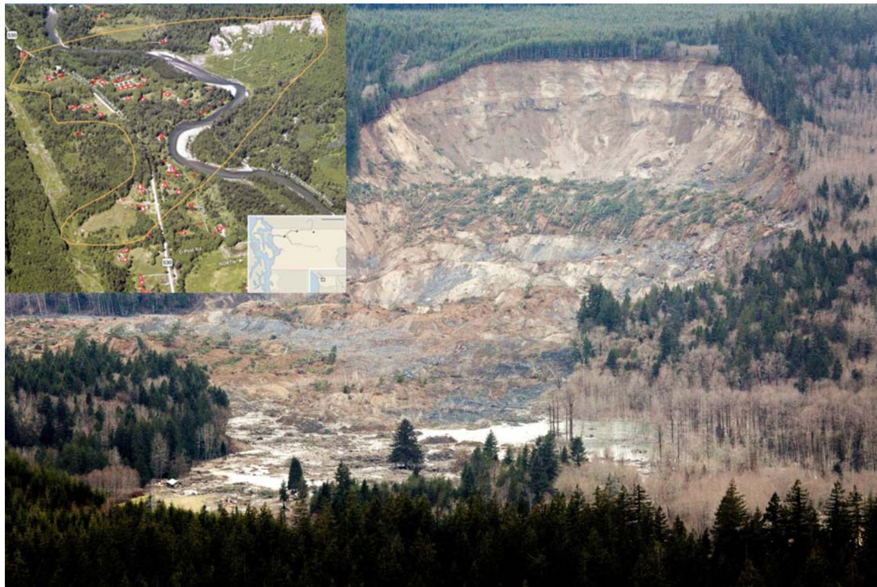
Slika 9 Klizište u mjestu Oso, Wasington, SAD (slika gore lijevo, desno gore rijeka Fork Stillaguamish, koju je klizište pregradilo; strelica pokazuje smjer klizanja, žutom linijom obilježen prostor rasprostiranja klizne mase, crveno – stambene zgrade,)
