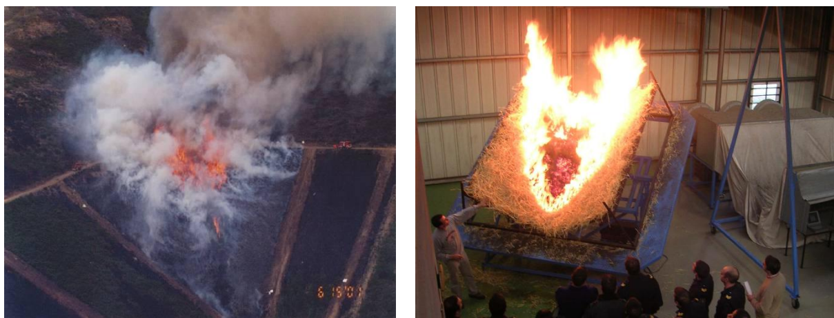
Slika 3.1. Probni poligon za proučavanje širenja požara na strmini u Portugalu 2001. (lijevo) i Forest Fire Research Laboratory (desno), (Viegas, 2007).
