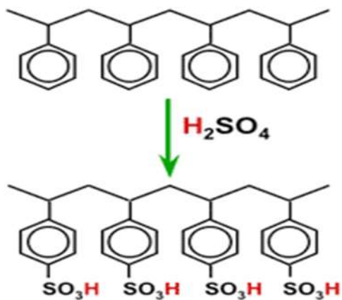
Slika 3. Nastajanje jako kiselog izmjenjivača sulfoniranjem (Dardel, 2013)
