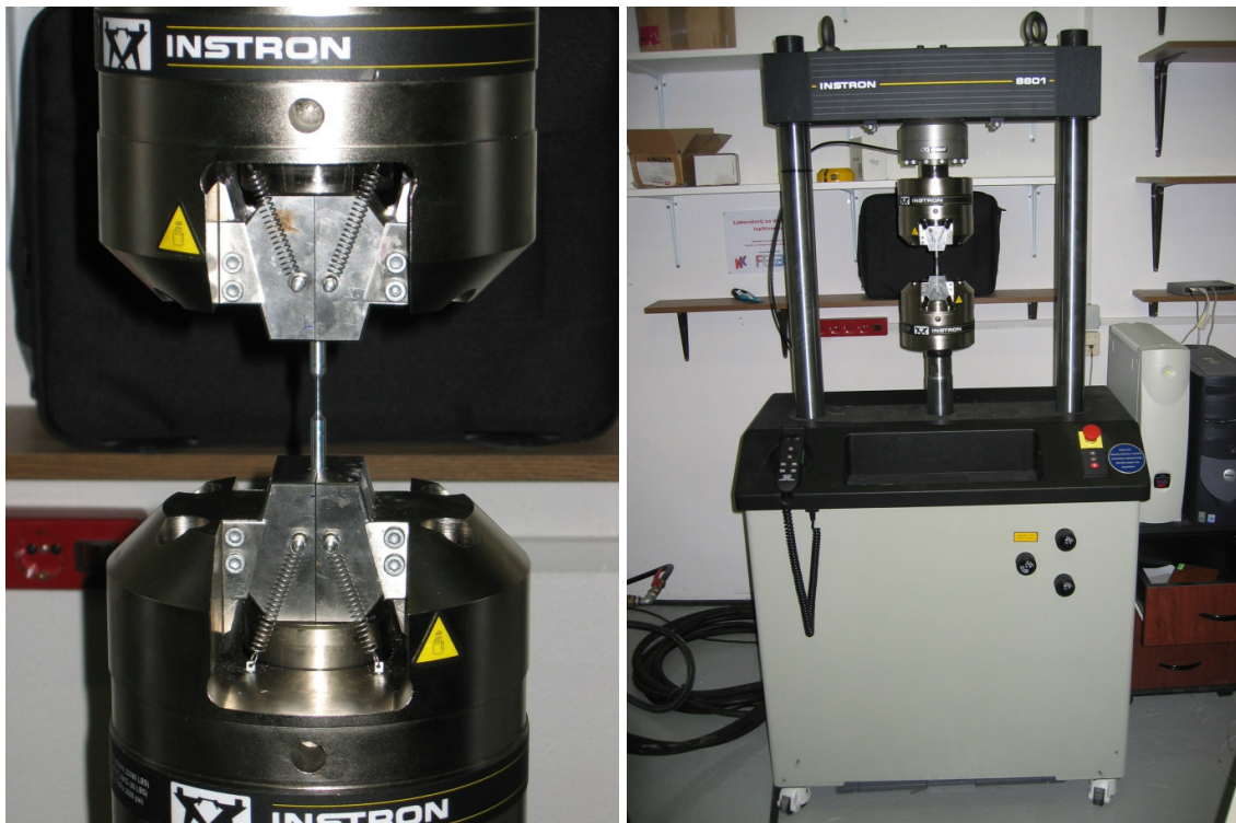
Slika 3.2.1 Ispitivanje epruvete Al-legure na kidalici
