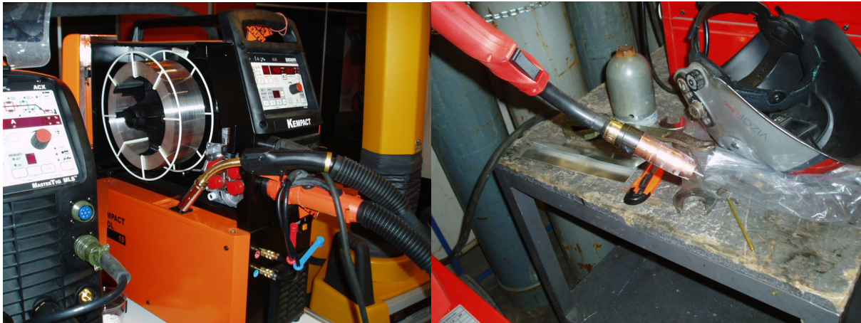
Slika 5.3.2 MIG postupak zavarivanja (automatski dovod dodatnog materijala)
