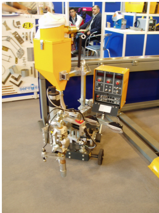
Slika 5.3.4. Zavarivanje pod prahom (automatski dovod dodatnog materijala)
