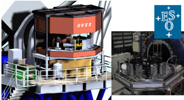
**Slika 4.2:** UVES spektrograf na VLT teleskopu, s kojim su snimljeni spektri kvazara (izvor: [www.eso.org/instruments/uves/](http://www.eso.org/instruments/uves/))
