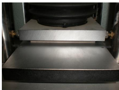
Slika 56. Provođenje FCT ispitivanja, otpornosti na ravnu tlačnu silu.
