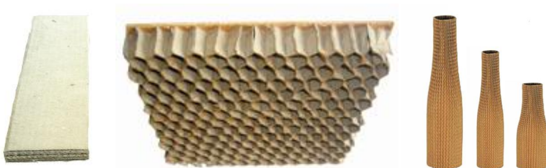
Slike 12., 13. i 14. Unakrsna valovita ljepenka. ukočeno saće i ondulij.
