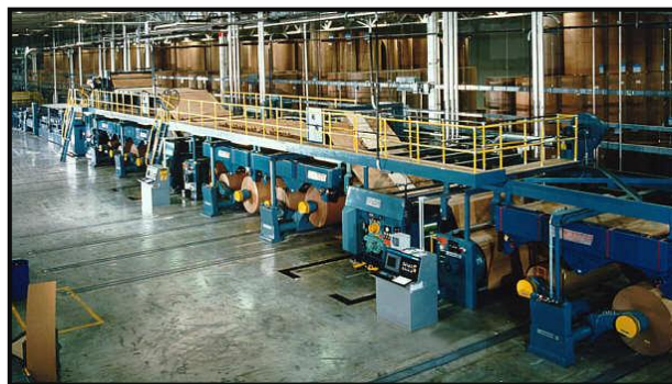
Slika 8. Stroj za izradu troslojnog i peteroslojnog valovitog kartona.
