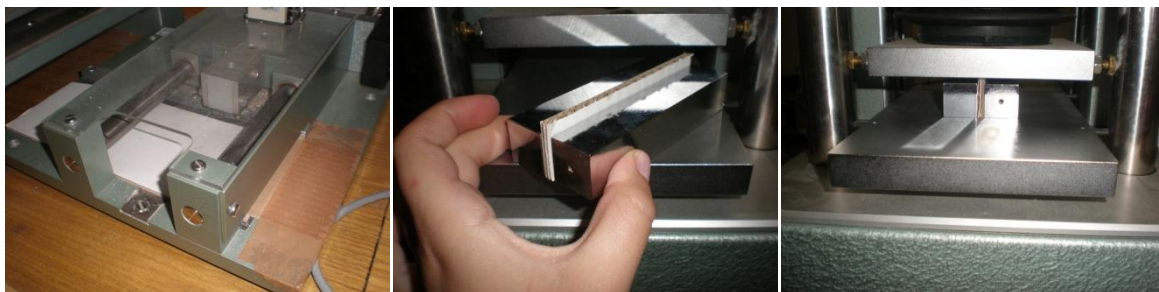
Slike 57., 58. i 59. ECT rezač uzoraka, umetanje valovitog kartona u CT pomoću dva metalna potporna bloka te sama provedba ECT ispitivanja.
