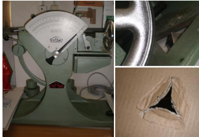
Slike 52., 53. i 54. Uređaj FRANK za ispitivanje otpornosti valovitog kartona na dinamičko probijanje.
