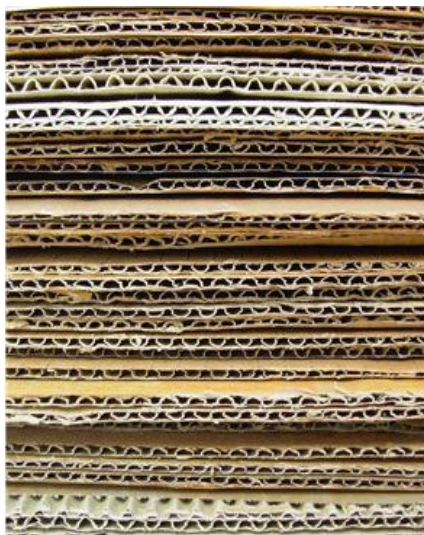
Slika 1. Presjek različitih ploča valovitog kartona, naslaganih jedna na drugu.
