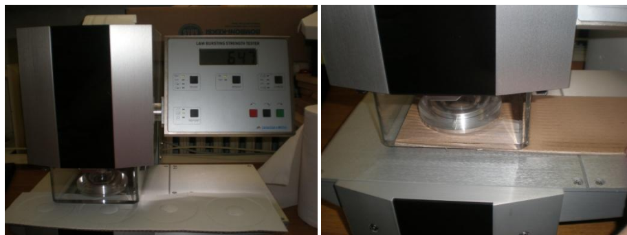
Slike 60. i 61. Bursting Strenght Test , ispitivanje otpornosti valovitog kartona na statičko probijanje.
