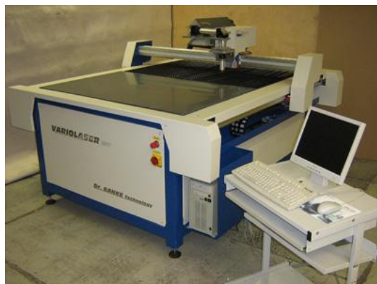
Slika 48. Laserski rezač – ploter za valoviti karton.
