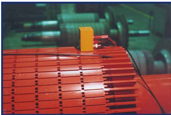
Slika 3.12. Položaj uzbudnog senzora pri mjerenju vodljivosti rotorskih štapova
