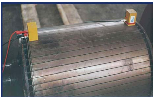
Slika 3.14. Mjerenje vodljivosti rotorskih štapova
