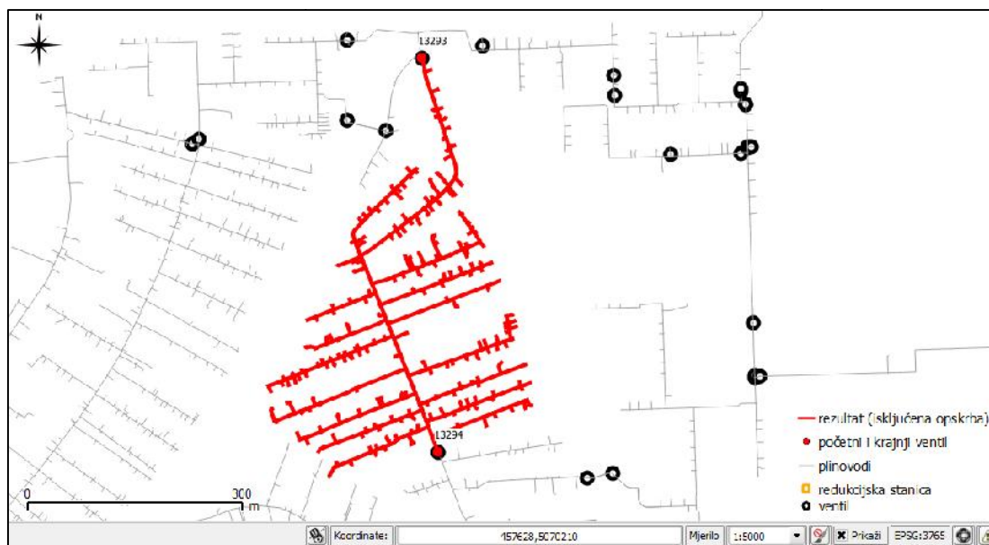
Slika 18. Prikaz rezultata identifikacije svih linijskih segmenata između ventila 13293 i 13294
