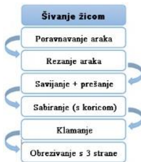
Slika 30. Tehnološka shema MUK - ručno šivanje žicom kroz hrbat (klamanje)
