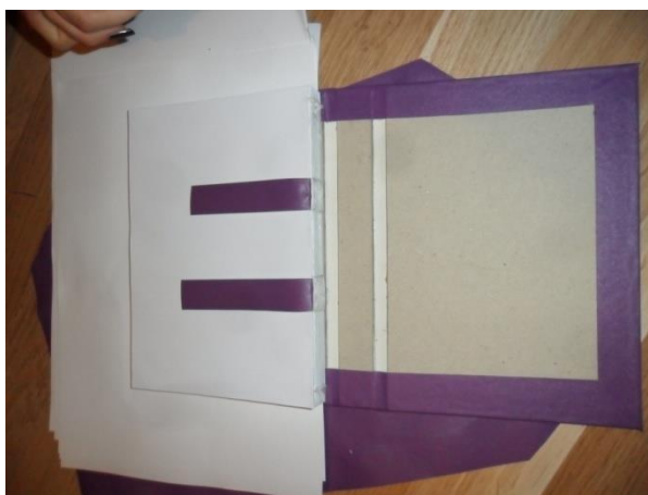
Slika 80. Naljepljivanje podstave na višedijelne tvrde korice
