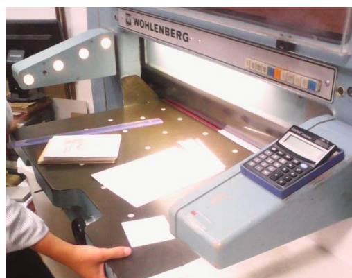
Slika 24. Obrezivanje na brzorezaču
