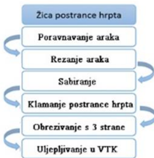
Slika 32. Tehnološka shema TUK - šivanje žicom postrance hrpta
