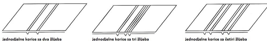
Slika 36. Žlijebovi na jednodijelnim kartonskim koricama
