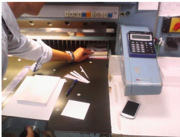
Slika 77. Obrezivanje na brzorezaču
