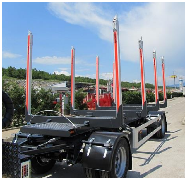
Slika 29. Prikolica za prijevoz drva PSM 200
