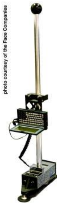
Slika 21. Dipstick profiler (Izvor: www.dipstick.com )
