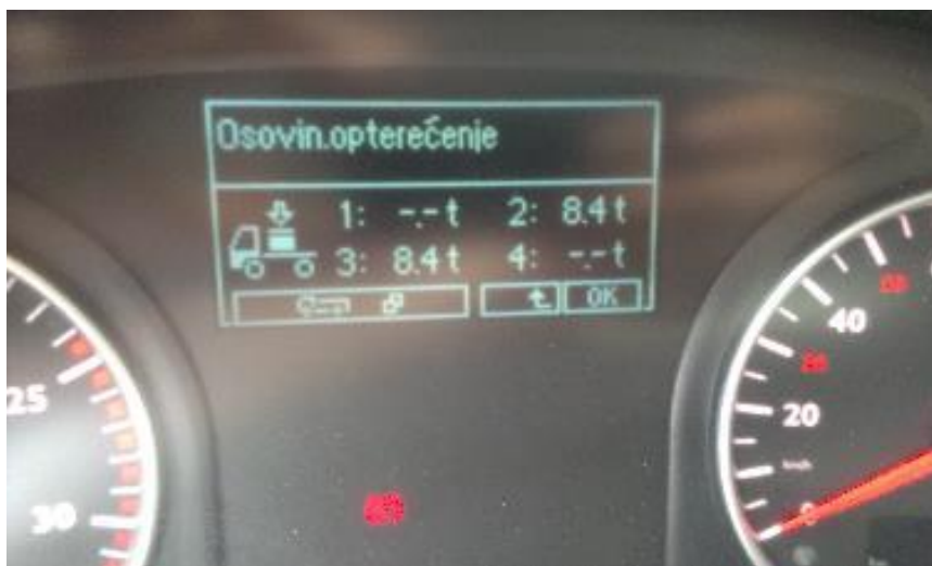
Slika 39. Prikaz izmjerenih osovinskih opterećenja u kabini kamiona
