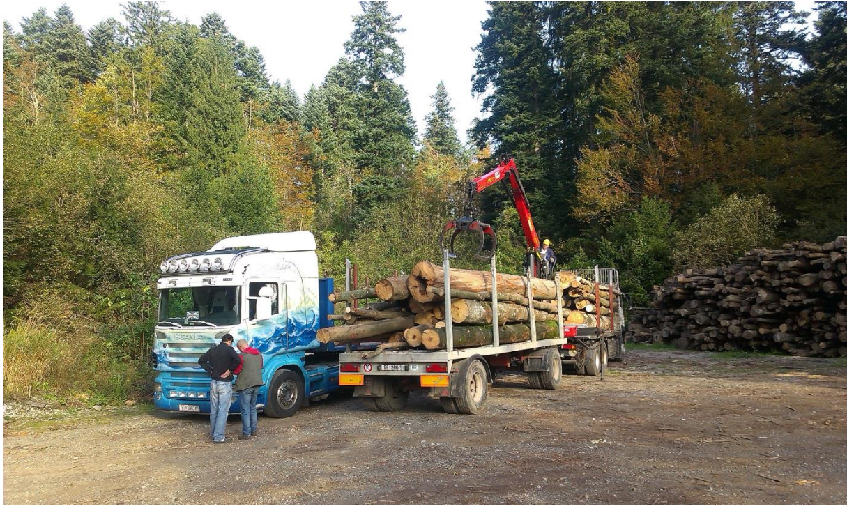
Slika 23. Utovar šumskog tegljačkog skupa na pomoćnom stovarištu uz javnu prometnicu
