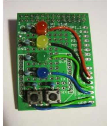
Slika 2.4.2 Električna shema i izgled spoja s 3 LED žarulje i 2 tipke [3]
