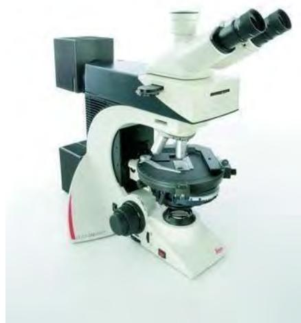
Sl. 62. Jedan od modela polarizirajućih mikroskopa tvrtke Leica<sup>86</sup>
