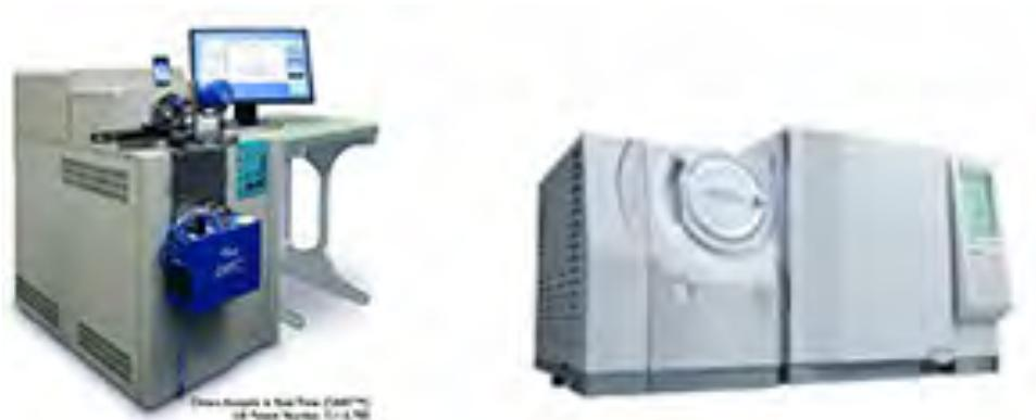
Sl. 84. Jedan od modela masenih spektrometara: maseni spektrometar Jeol AccuTOF™ DART®<sup>174</sup>. Desno, Jedan od modela kombiniranog uređaja plinskoga kromatografa i masenoga spektrometra: Shimadzu GCMS-QP2010 Ultra High-End GC-MS.
