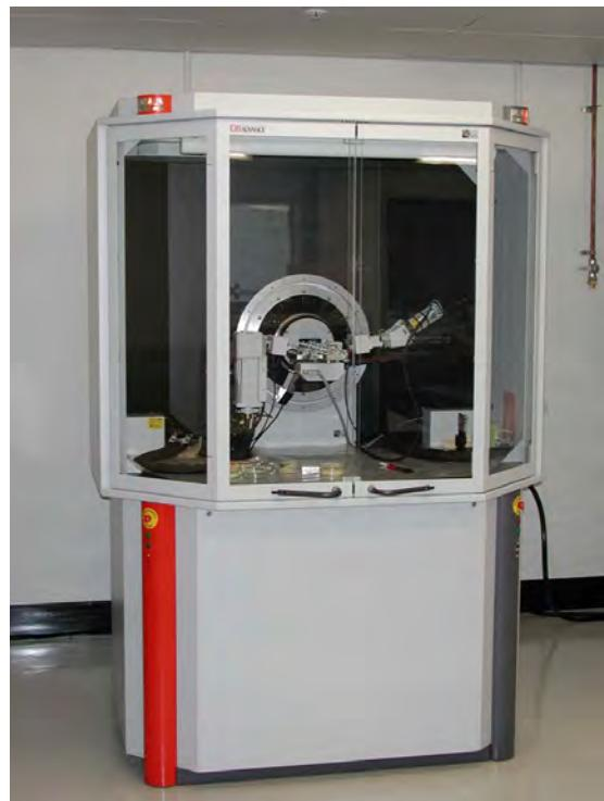
Sl. 73. Jedan od modela XRD analizatora (difraktometara).<sup>118</sup>
