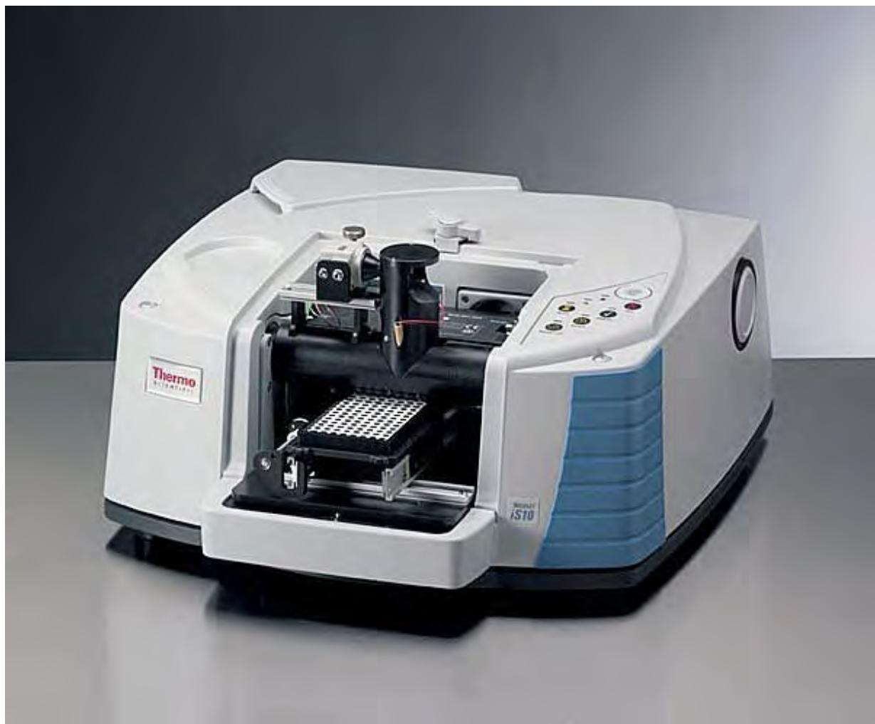
Sl. 75. Jedan od modela FT-IR spektrometara (s ATR dodatkom).<sup>123</sup>
