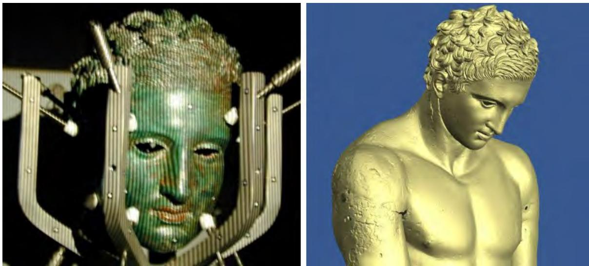
Sl. 61. 3D digitalizator projicira uzorke linija i bilježi ih pomoću dviju digitalnih kamera na fiksiranoj međusobnoj udaljenosti<sup>83</sup> Pojedinačna snimanja automatski se digitalno poklapaju u jednu cjelinu pomoću prethodno određenih fotogrametrijskih točaka<sup>84</sup>
