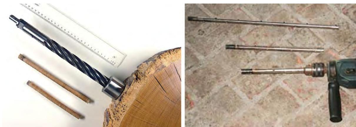
Sl. 85. Svrdo za minimalno destruiranje drva uzorkovanjem za dendrokronologiju.<sup>179</sup> Desno, svrdla razne duljine za minimalno destruiranje drva za uzorkovanje pomoću bušilice.<sup>180</sup>
