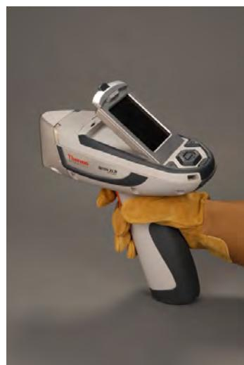
Sl. 64. Jedan od prijenosnih modela XRF-a tvrtke Thermo Scientific primarno primjeren za elementnu analizu legura<sup>92</sup>
