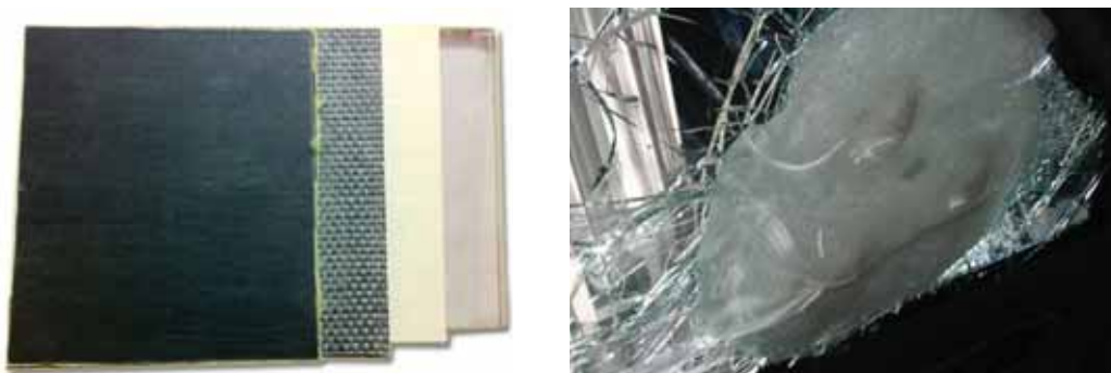
Slika 3. Materijali od karbonskih vlakana i polikarbonatsko staklo ( www.texasarmoring.com )
