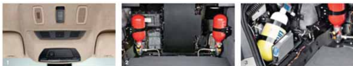
Slika 10. S lijeva na desno: u slučaju nužde gumb za odbacivanje vjetrobranskog stakla eksplozivnim punjenjem, protupožarni sustav i boce s kisikom.
