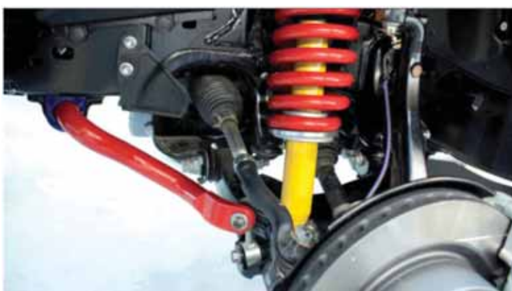
Slika 16. Ojačanje ovjesa zbog povećane vlastite mase vozila
