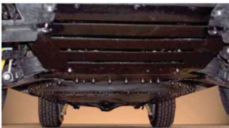
Slika 15. Zaštita poda i spremnika za gorivo
