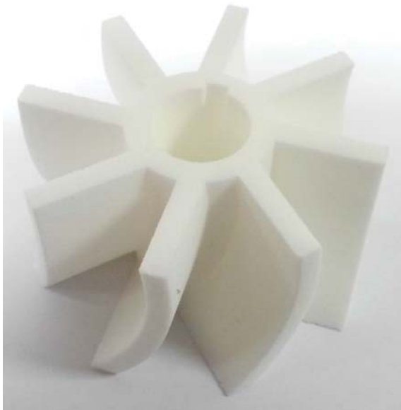
Figure 7. Workpiece made by Selective Laser Sintering process Slika 7. Izradak dobiven postupkom selektivnog laserskog sinteriranja
